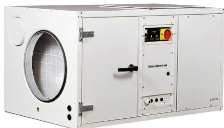
Le déshumidificateur fonctionne selon le principe de la condensation frigorifique. Un ventilateur aspire l'air ambiant et le dirige sur l'évaporateur. L'air est refroidi et la vapeur d'eau ainsi condensée est recueillie par le réceptacle et est évacuée. L'air maintenant sec passe sur le condenseur ou il est réchauffé avant d'être réintroduit dans le local – lors du passage de l'air dans le déshumidificateur, la température augmente d'environ de 5 °C.
