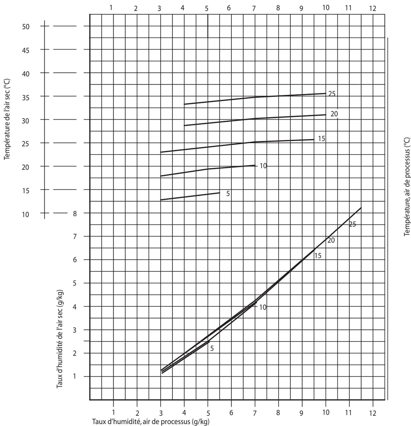
Le diagramme de capacité vaut pour une quantité d'air régénéré d'environ 85 m<sup>3</sup>/h (correspond à 8 A sur l'ampèremètre), et une quantité d'air sec nominale de 400 m<sup>3</sup>/h.
