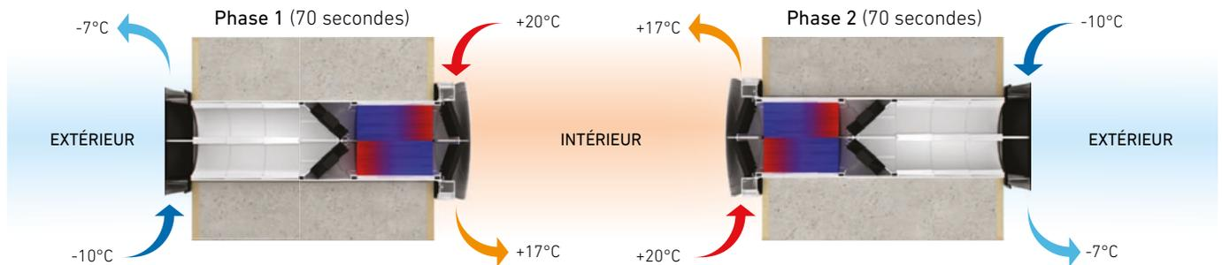
Un ventilateur fournit de l'air frais de l'extérieur, qui traverse la partie en céramique et absorbe la chaleur et l'humidité accumulées que cette dernière a accumulées. En même temps, un autre ventilateur extrait l'air chaud
